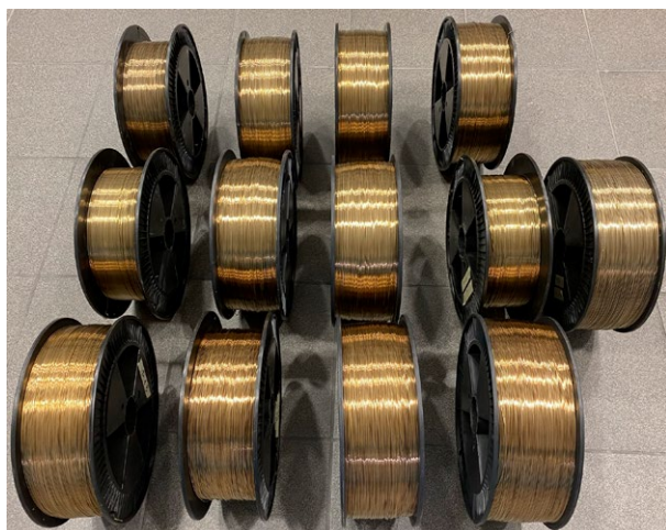
ZDJĘCIE 1. Autorskie druty Cu-Al-Mn-Ni-Fe – materiał wsadowy do technologii druku 3D_WAAM
