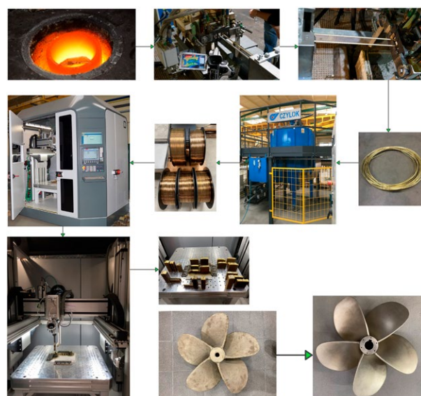
ZDJĘCIE 2. Kompleksowa technologia wytwarzania śrub okrętowych w technologii druku 3D_WAAM
