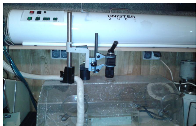
Połączenie Modułu Sterylizacji (MS) z komorą rękawicową do preparatyki laboratoryjnej (przykład wydzielonej przestrzeni chronionej MWCPA)
