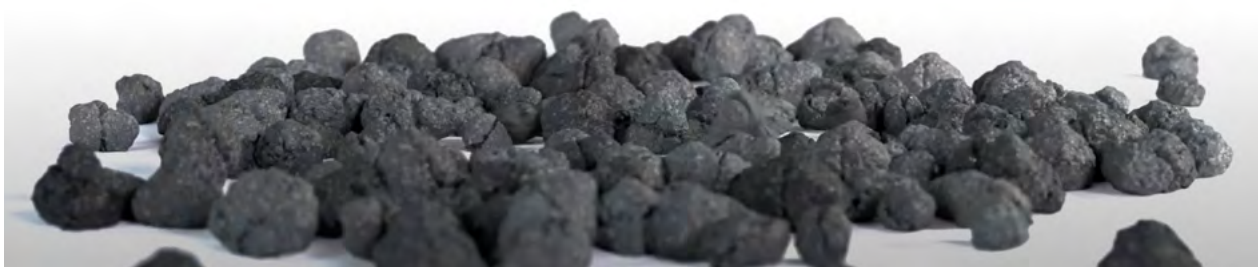
Rysunek 1. Lekkie kruszywo kompozytowe CLA uzyskane z odpadów tworzyw sztucznych i popiołów
