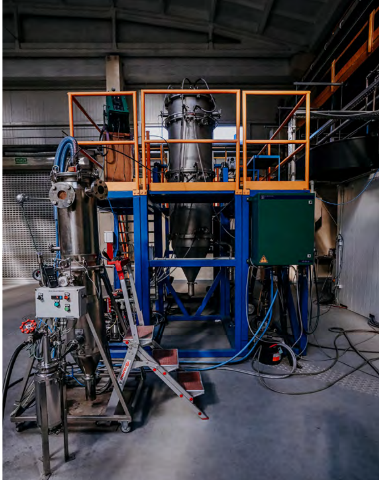
Rysunek 2. Unikatywne systemy do sferoidyzacji plazmowej w skali laboratoryjnej oraz półtechnicznej.
