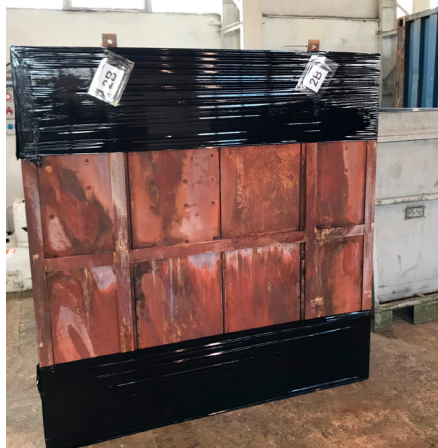
Fig. 3. Katalizator przemysłowy po procesie regeneracji gotowy do zamontowania w elektrowni
