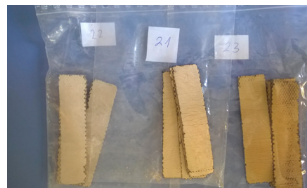
Fig. 7. Wizualne porównanie katalizatorów deNOx od lewej: katalizator fabrycznie nowy; katalizator regenerowany; katalizator zdezaktywowany.
