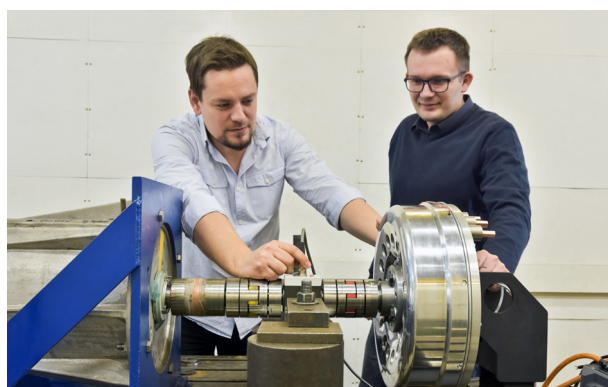
Silnik do montażu w piastach kół – badania laboratoryjne
