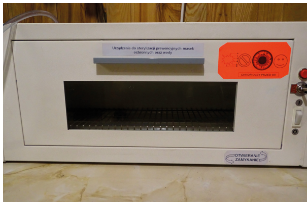
Fig. 1 Prototyp sterylizatora masek ochronnych i wody
