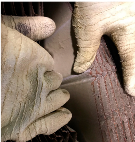
Fig. 2. Katalizator przemysłowy po procesie regeneracji.
