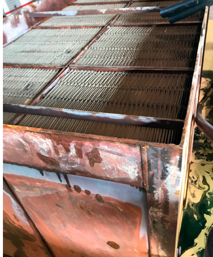
Fig. 4. Jeden z etapów regeneracji bloku katalizatora przemysłowego.
