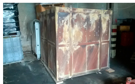
Fig. 5. Zdezaktywowany blok katalizatora przed regeneracją.
